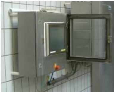
Bild2: Typische Work-Around-Lösung in der Lebensmittelindustrie: Der Industrie-PC wird durch einen teuren Schutzschrank vor den Einwirkungen der Hochdruckreinigung geschützt, was zudem die Bedienung erschwert.
