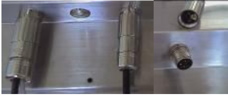
Bild2: Schnittstellen und Stromzufuhr sind beim Penta Food Panel-PC über IP69k geschützte und fest integrierte Steckschraubverbinder mit exakt an die Kabel angepassten Kabelklemmen ausgeführt.
